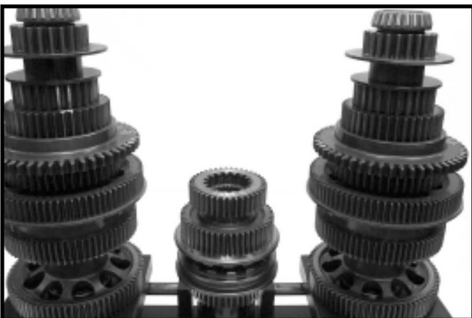
12.Remove 2<sup>nd</sup> gear, 2<sup>nd</sup>/3<sup>rd</sup> gear clutch collar and 3<sup>rd</sup> gear
