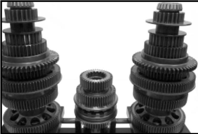
6. Install 2<sup>nd</sup> gear, 2<sup>nd</sup> / 3<sup>rd</sup> gear clutch collar and 3<sup>rd</sup> gear
